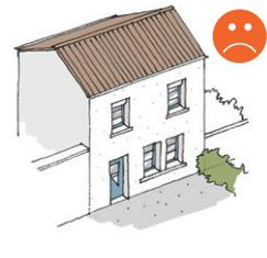
4/ Pose d'enduit cimenté sur la pierre et la chaux initiales, pose de volets roulants extérieurs en PVC, imperméabilisation du jardin.
