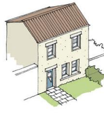
3/ Nouvelles menuiseries, percement d'une nouvelle fenêtre, remplacement des tuiles en terre cuite par des tuiles en ciment.
